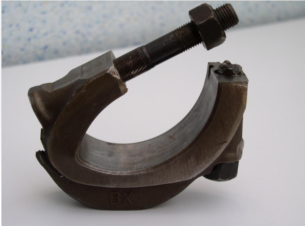
Gebrochene Lagerschale eines Pleuels von einem Caterpillar-Blockheizkraftwerk
